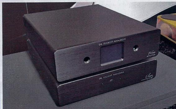
Noch im Prototypen-Stadium, aber sehr vielversprechend: genauestens per Fernbedienung auf alle Tonabnehmer anpassbarer, trotzdem völlig analog-puristisch aufgebauter Phono-Vorverstärker von Dr. Feickert. Darunter das abgesetzte Netzteil.
